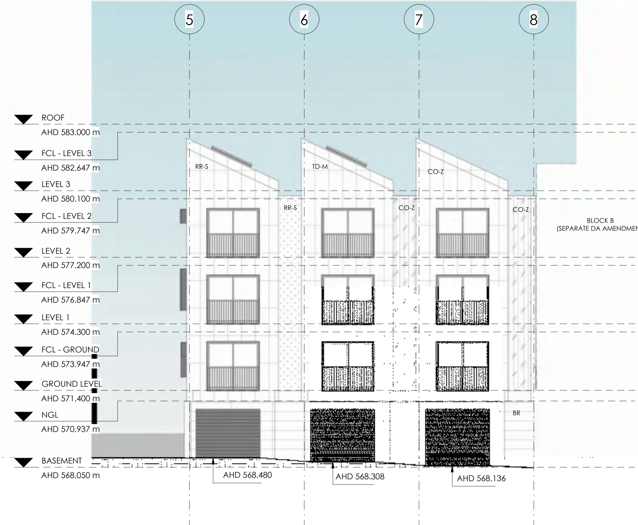
3 DA - INTERNAL ELEVATION - NORTH SCALE: 1:100
